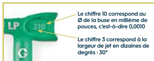
Le chiffre 10 correspond au Ø de la buse en millième de pouces, c'est-à-dire 0,0010
