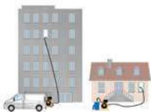
Grâce à son enrouleur hydraulique vous pouvez réaliser un enroulage et un déroulage assisté en toute sécurité sans effort jusqu'à 80 mètres en enduit (soit environ 9 étages) en conservant une bonne amplitude de travail et jusqu'à 120 mètres en peintures.
